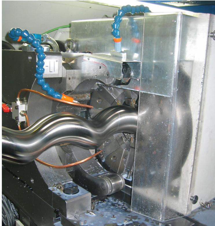
Unter Einsatz der Burgsmüller Wirbel- und Frästechnik werden weltweit Produkte wie Spindeln, Muttern, Pumpenrotoren oder auch Schnecken- und Schneckenelemente, Kurbel- oder Nockenwellen gefertigt.
